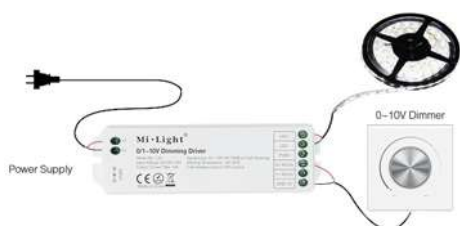
تنظیم نور خروجی چراغ با دایمر 1-10VDC
