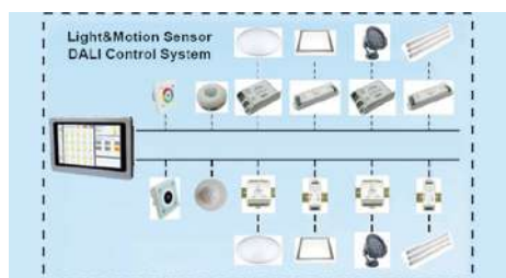
ارتباط چراغ، سنسور، پنل کنترل و غیره بر روی یک خط DALI
